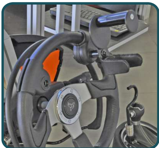
2 griffe al volante con 3 impugnature (pomello/forcella/tripode)
